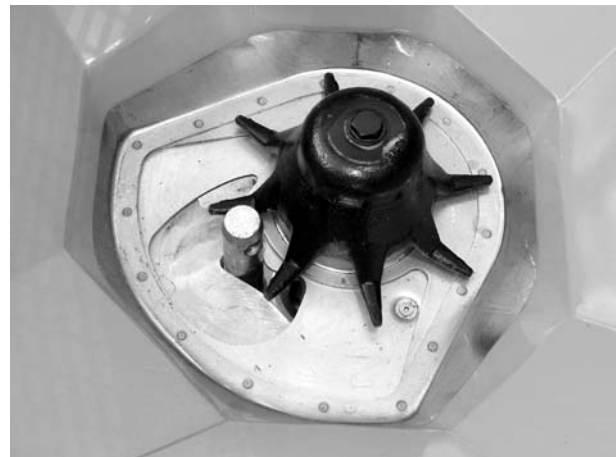
Bild 20: Unterlenkerbolzen in Dosieröffnung
