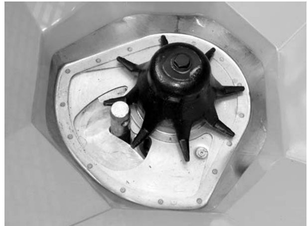
Bild 25: Unterlenkerbolzen in Dosieröffnung
