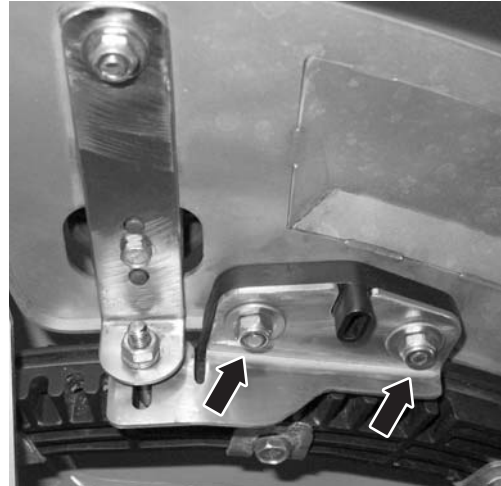
Bild 28: Justageblech Aufgabepunkt lösen
