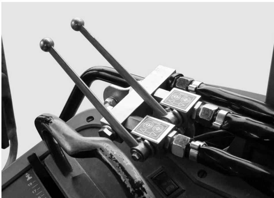
Bild 8: Schieberbetätigung der Zwei-Wege-Einheit
