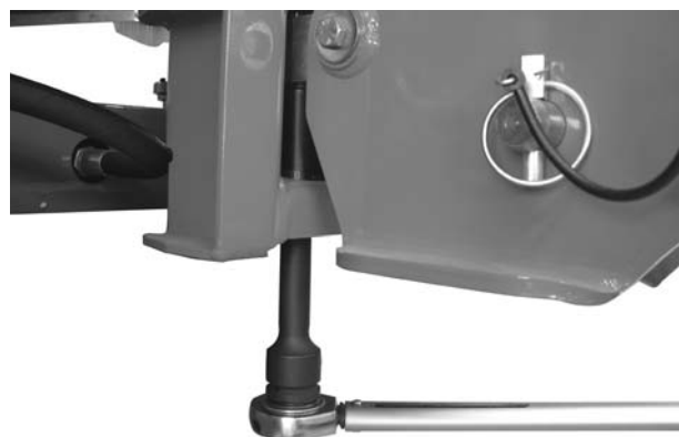
Bild 18: Befestigung der Wiegezelle (in Fahrtrichtung links)
