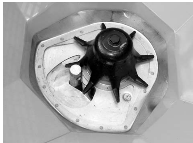
Bild 22: Unterlenkerbolzen in Dosieröffnung
