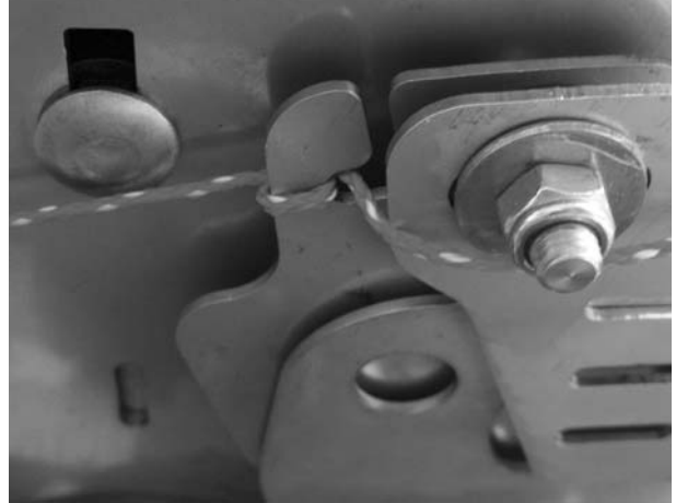
Bild 35: Schnur an Einstellcenter anlegen
