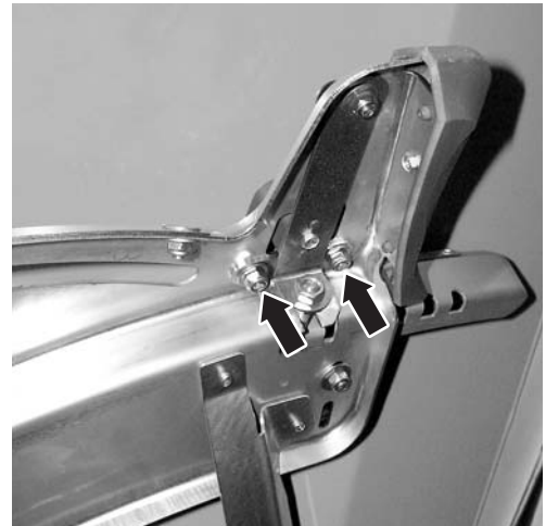
Bild 25: Justageblech Aufgabepunkt lösen
