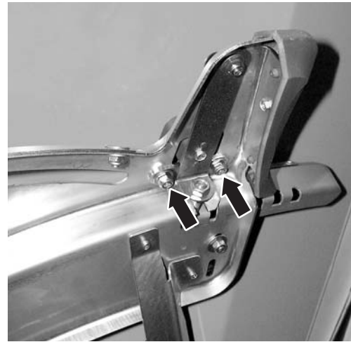
Bild 34: Justageblech Aufgabepunkt lösen
