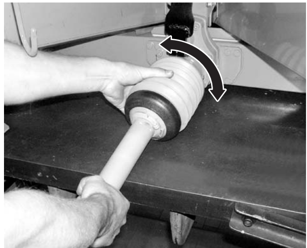
図 7.4: ドライブシャフトガードを装着
