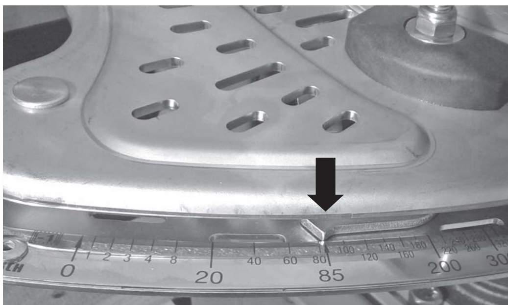
図 10.23: 計測スライドのポインターをポジション 85 に設定
