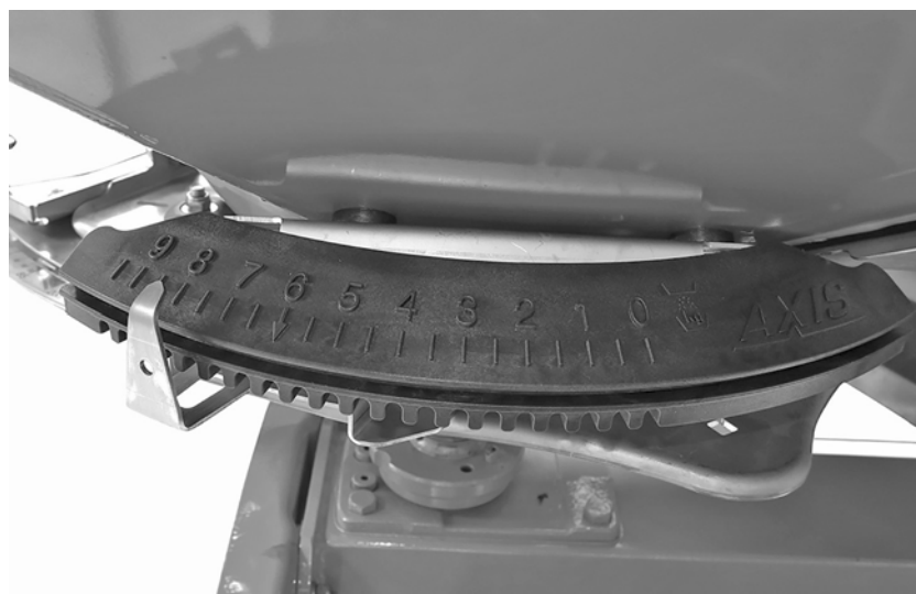
図 8.6: 放出ポイント調整の様子
