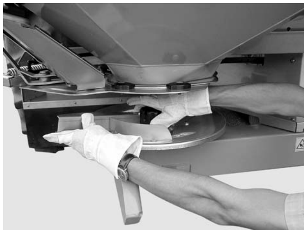
8.16. attēls: Kupoluzgriežņu pieskrūvēšana
