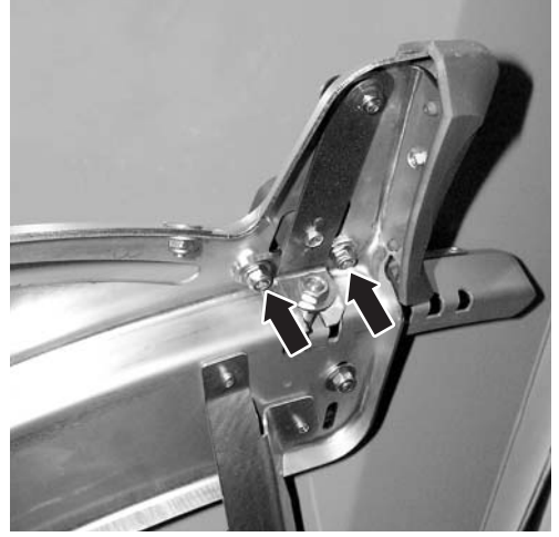
Resim 10.26: Gübre bırakma noktası düzeltme levhasının sökülmesi
