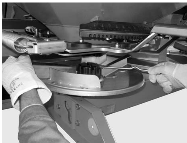
Slika 8.3: Zrahljajte klobučaste matice.
