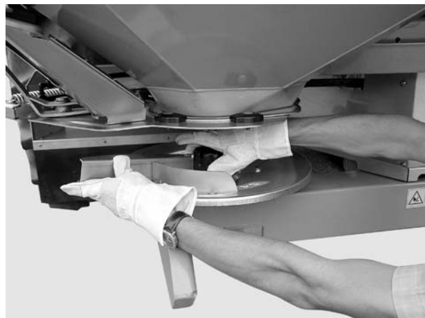
8.16 pav.: Gaubiamosios veržlės užveržimas
