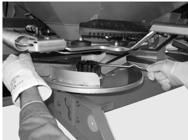
8.13 pav.: Gaubiamosios veržlės atlaisvinimas
