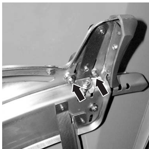
Joonis 10.26: Pealeandepunkti justeerimisplaadi vabastamine
