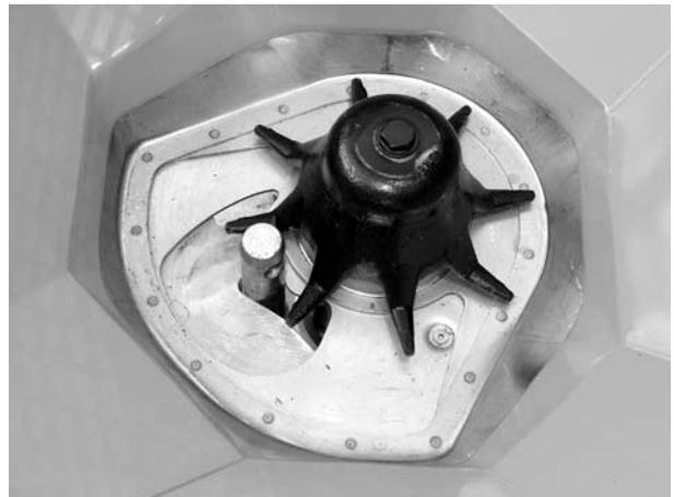
10.18 ábra: Alsó összekötőcsap az adagolónyílásban
