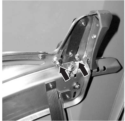
Slika 10.26: Otpuštanje lima za podešavanje tačke predavanja
