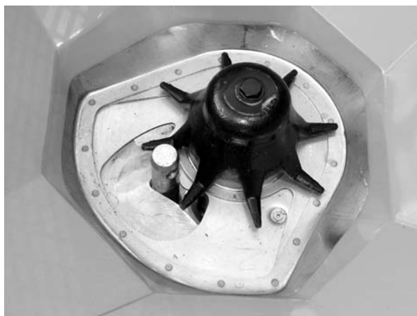
Slika 10.18: Klin donjeg hidrauličnog podizača u otvoru za doziranje
