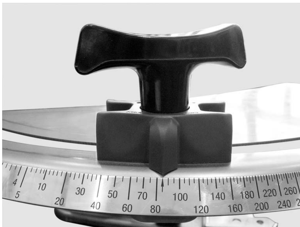
Slika 10.19: Podešavanje skale klizača za doziranje
