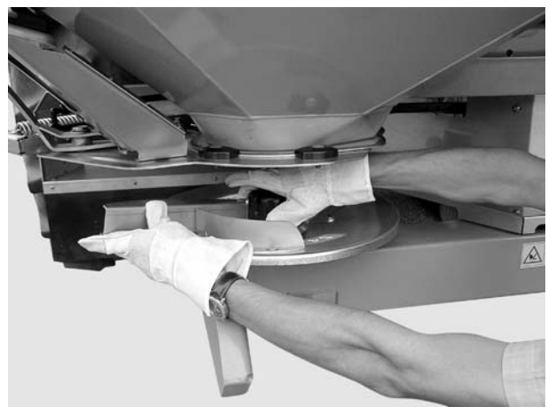
Slika 8.16: Navrtanje slepe navrtke
