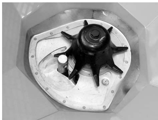
Bilde 10.18: Trekkstangbolt i doseringsåpning
