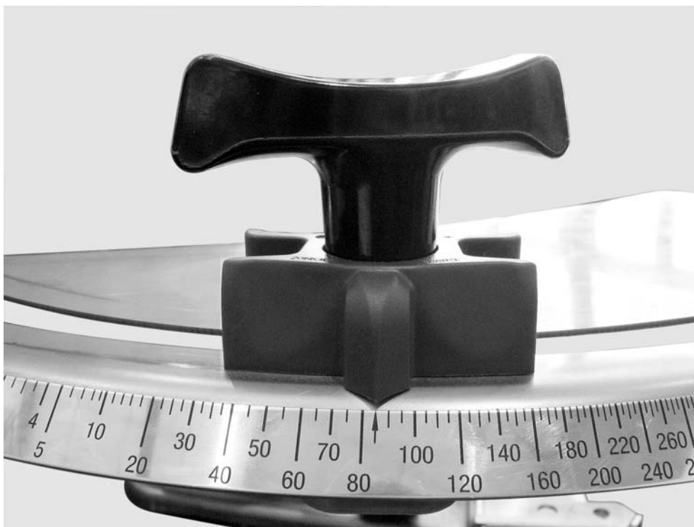
Bild 10.19: Skala för inställning av doseringssliden
