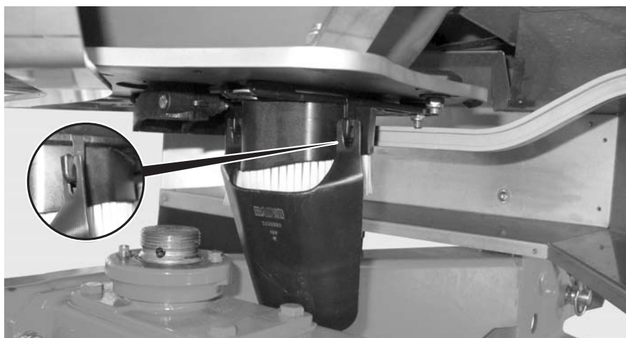
Imagen 8.14: Enganchar el plano inclinado de prueba de giro
