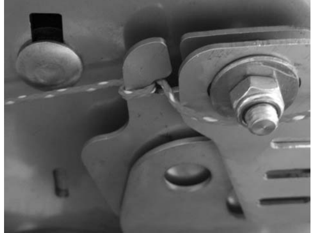
Imagen 10.27: Colocar cordón en el centro de ajuste
