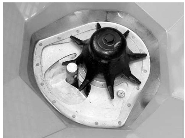
Imagen 10.18: Perno de brazo inferior de enganche en el orificio de dosificación
