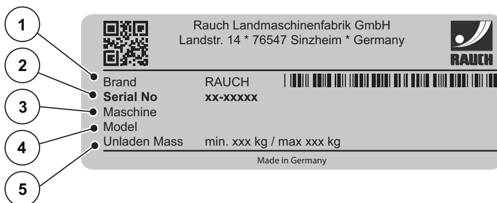
Imagine 3.5: Plăcuța cu datele producătorului
