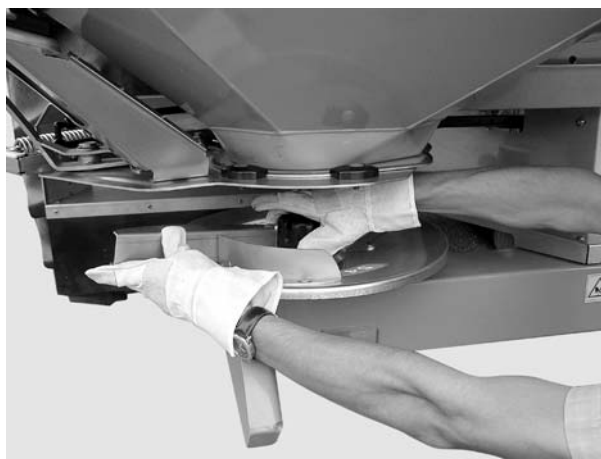
Imagine 8.16: Înșurubați piulița cu pălărie
