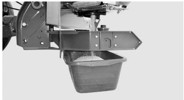
Εικόνα 8.15: Εκτέλεση δοκιμής βαθμονόμησης
