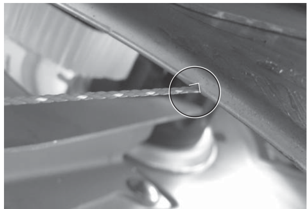
Εικόνα 10.28: Σήμανση στο κέντρο ρύθμισης
