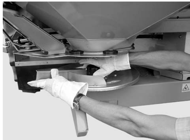
Εικόνα 8.16: Βίδωμα τυφλού παξιμαδιού
