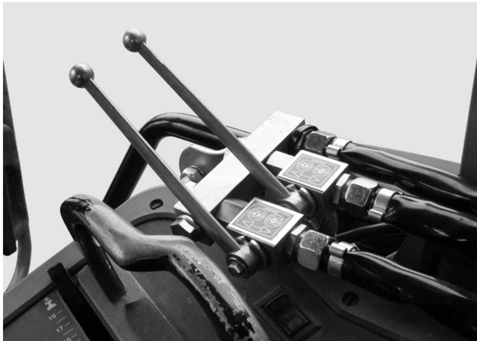
Мал. 7.8: Гідравлічний пристрій керування заслінкою двоходового блока За допомогою кульових кранів двоходового блока можна окремо керувати заслінками дозатора.
