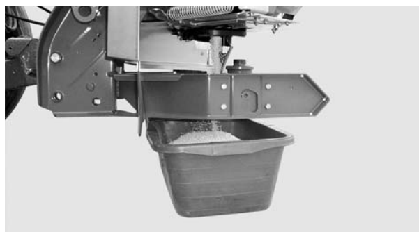
8.15. attēls: Dozēšanas izmēģinājumu veikšana
