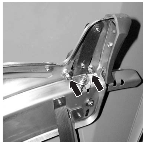
10.21. attēls: Padeves punkta regulēšanas plātnes atbrīvošana
