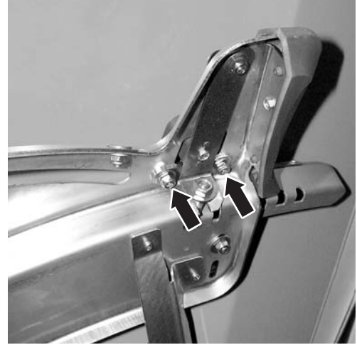
Resim 10.21: Gübre bırakma noktası düzeltme levhasının sökülmesi
