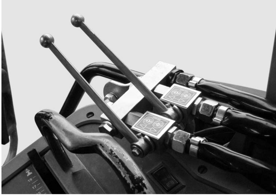
Resim 7.8: İki yönlü ünitenin sürgü tahrik tertibatı
