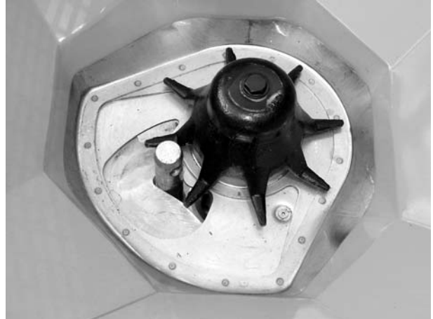
Resim 10.18: Dağıtım çıkışında alt bağlantı pimi
