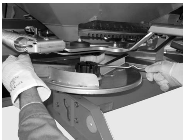
8.13 pav.: Gaubiamosios veržlės atlaisvinimas
