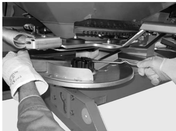
8.3 pav.: Gaubiamosios veržlės atlaisvinimas
