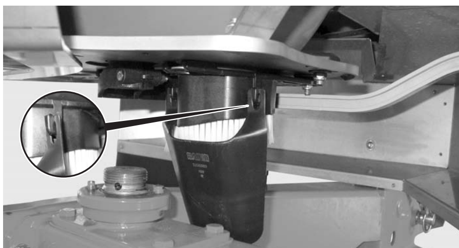
8.14 pav.: Išbėrimo normos nustatymo latako įkabinimas
