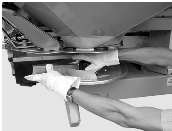
8.16 pav.: Gaubiamosios veržlės užveržimas
