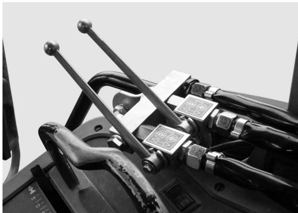
7.8 ábra: Kétutas szelep tolólapvezérlése
