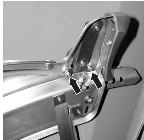
10.21 ábra: Munkapont állítólemezőnek kioldása
