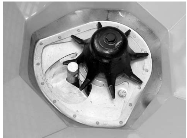
10.18 ábra: Alsó összekötőcsap az adagolónyílásban
