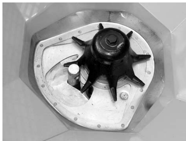
Bilde 10.18: Trekkstangbolt i doseringsåpning
