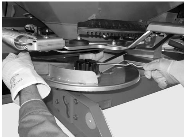
Obrázek 8.13: Povolení uzavřené matice
