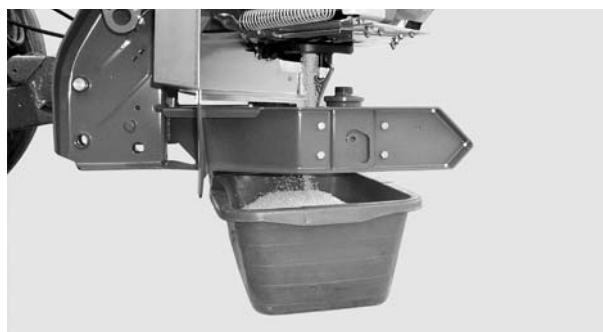
Obrázek 8.15: Provedení zkoušky dávky
