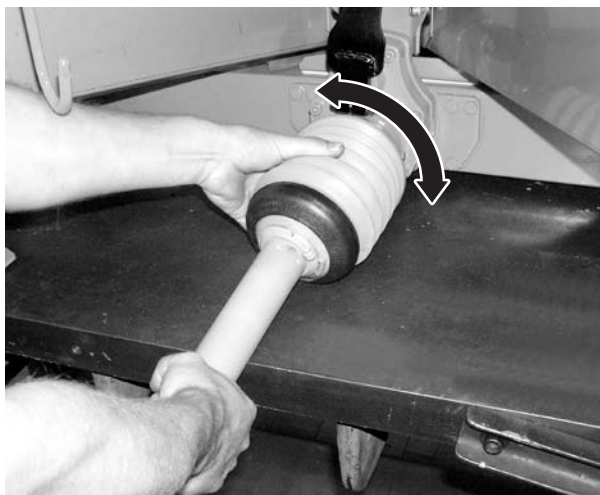
Obrázek 7.4: Ustavení kloubového hřídele
