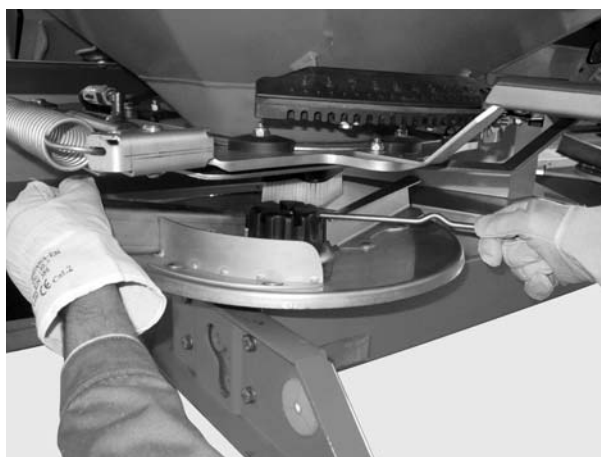
Obrázek 8.3: Povolení uzavřené matice
