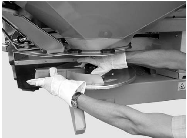
Obrázek 8.4: Odšroubování uzavřené matice
