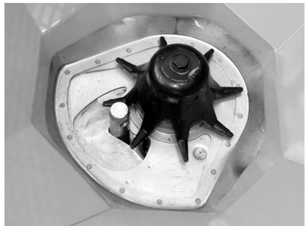
Obrázek 10.18: Čep spodní spojky v dávkovacím otvoru
