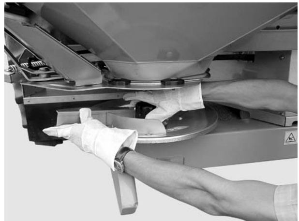
Obrázek 8.16: Zašroubování uzavřené matice
