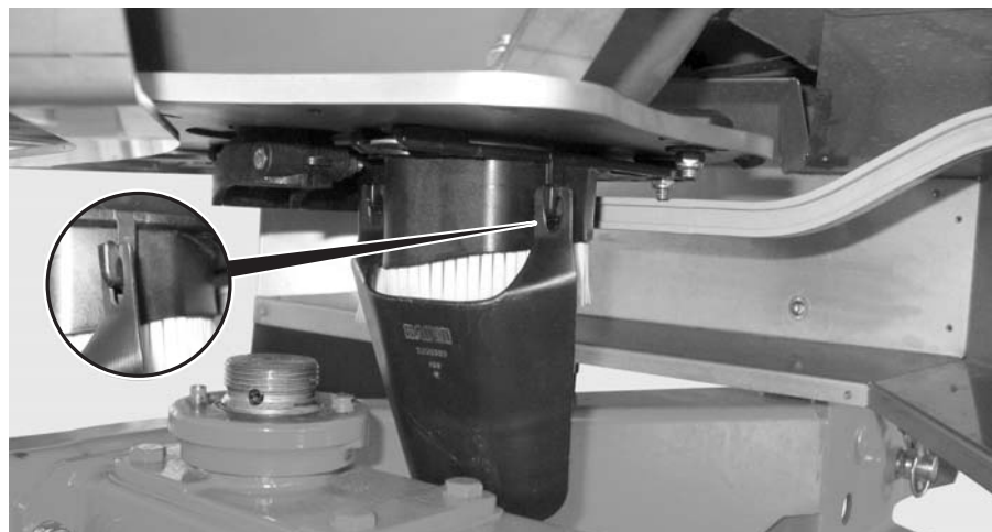
Bild 8.14: Sätt fast glidbanan för utmatningsprov
