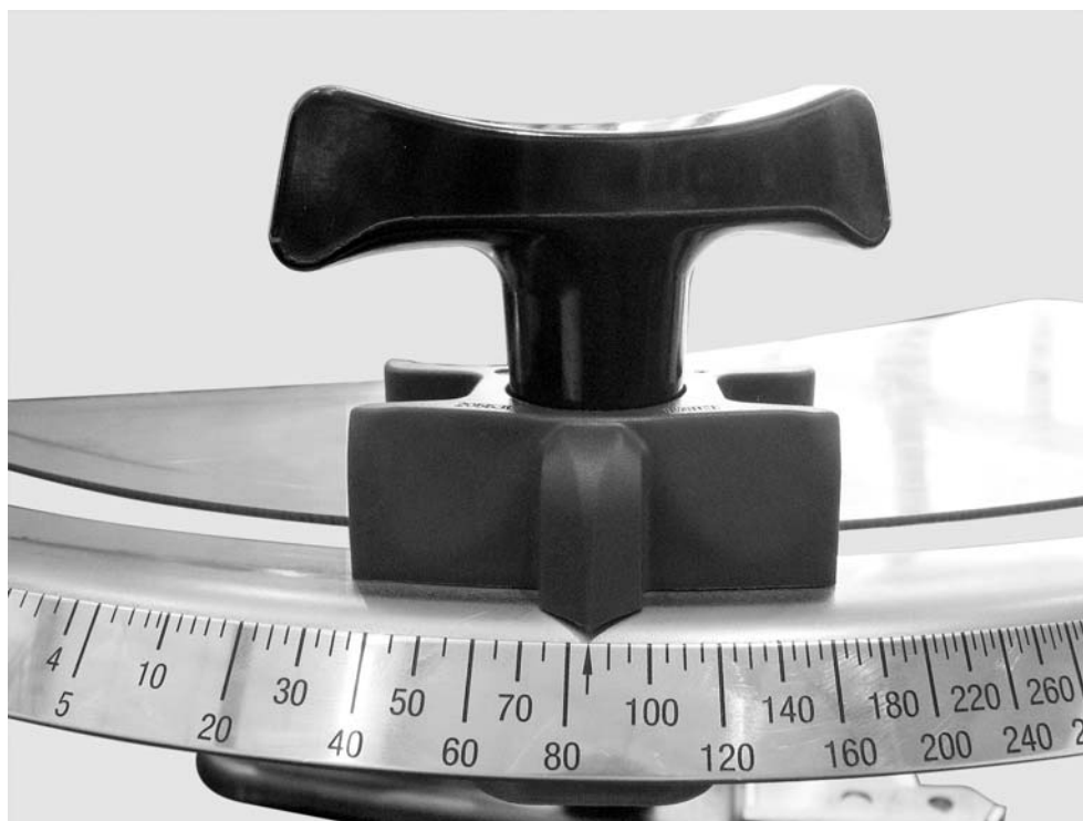
Slika 10.19: Skala za podešavanje zasuna za doziranje
