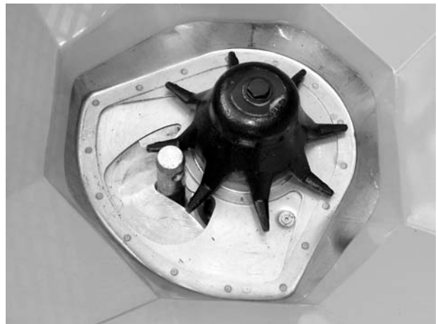
Slika 10.18: Klin donjeg cilindra u otvoru za doziranje
