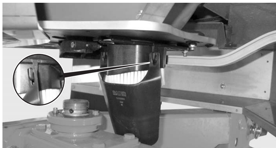
Slika 8.14: Vješanje kliznika za kalibraciju
