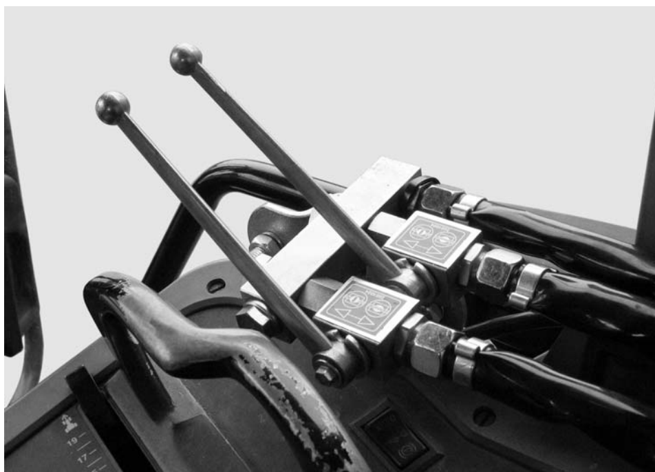
Slika 7.8: Uređaj za upravljanje zasunom dvosmjerne jedinice
