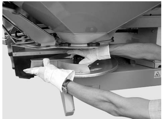
Slika 8.16: Zavijanje zaobljene slijepne matice
