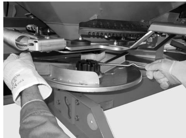
Slika 8.13: Otpustite zaobljenu slijepu maticu
