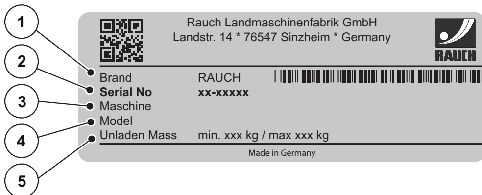
Imagen 3.5: Placa de fábrica
