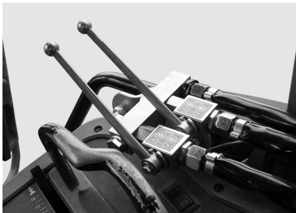
Afb. 7.8: Schuifbediening van de tweewegseenheid
