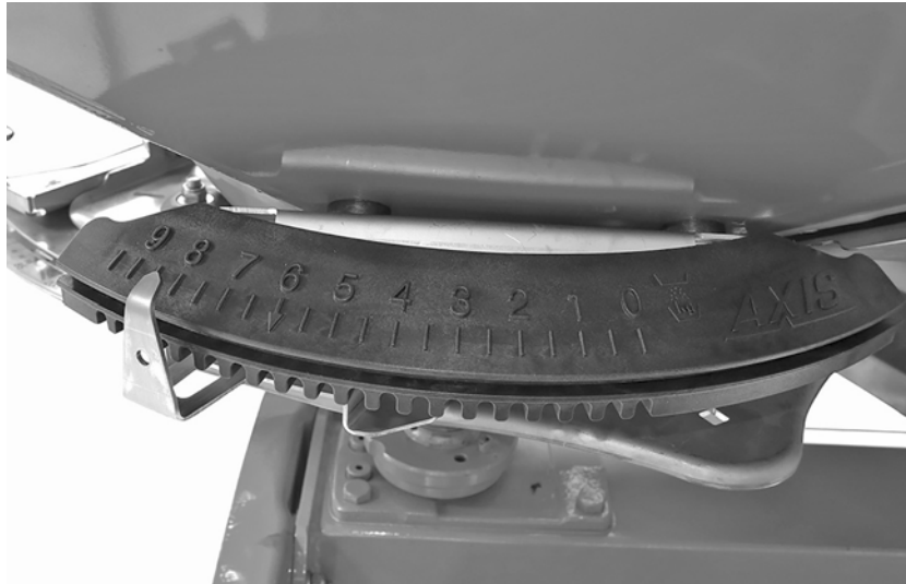
Mynd 8.6: Upplýsingar um útrenslisstað (dæmi)
