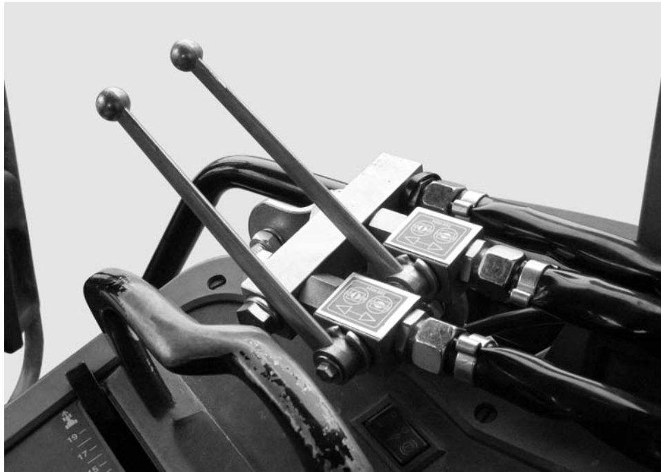
Mynd 7.8: Stýring skömmtunarops með tvíátta einingu
