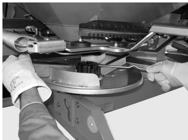
Εικόνα 8.3: Χαλάρωση τυφλού παξιμαδιού
