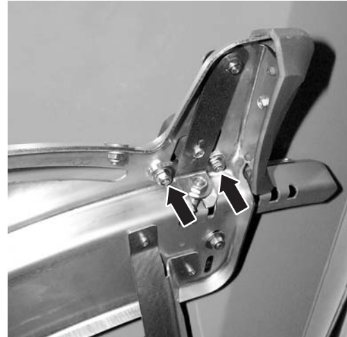
Εικόνα 10.21: Χαλάρωση ελάσματος ευθυγράμμισης σημείου εφαρμογής
