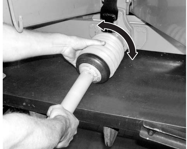
Εικόνα 7.4: Εφαρμογή προστασίας αρθρωτού άξονα
