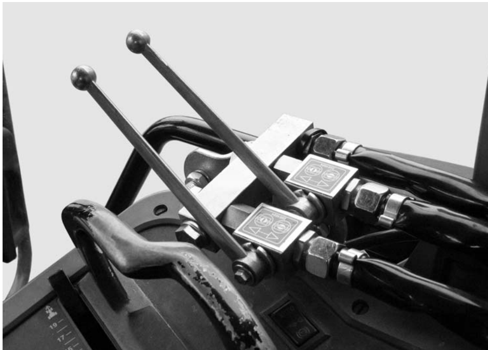
Εικόνα 7.8: Μηχανισμός θυρίδων της μονάδας δύο κατευθύνσεων Μέσω των ένσφαιρων βαλβίδων της μονάδας δύο κατευθύνσεων μπορείτε να ενεργοποιήσετε χωριστά την κάθε δοσιμετρική θυρίδα.
