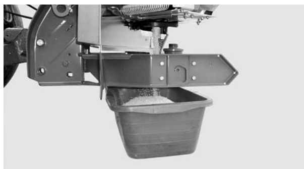
Фиг. 8.15: Изпълнение на калибриране
