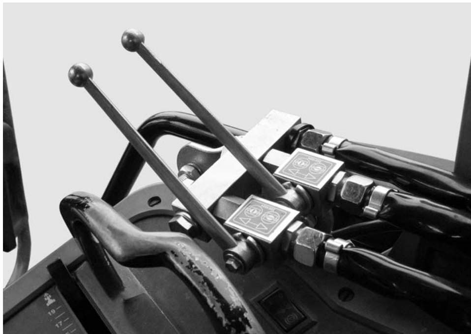
Фиг. 7.8: : Механизъм за задействане на шибърите на двупътния блок Дозиращите шибъри могат да се задействат по поотделно чрез сферичните кранове на двупътния блок.
