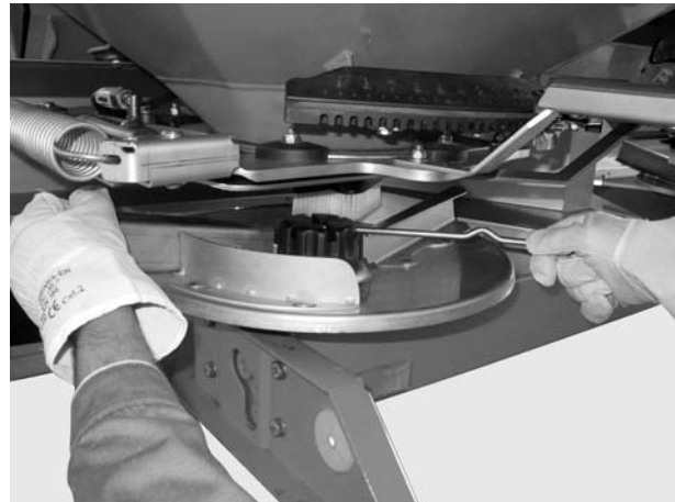
Rysunek 8.13: Luzowanie nakrętki kołpakowej
