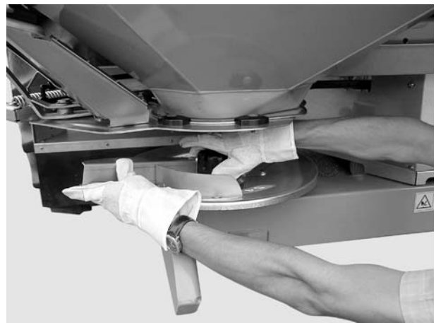
Rysunek 8.16: Przykręcanie nakrętki kołpakowej
