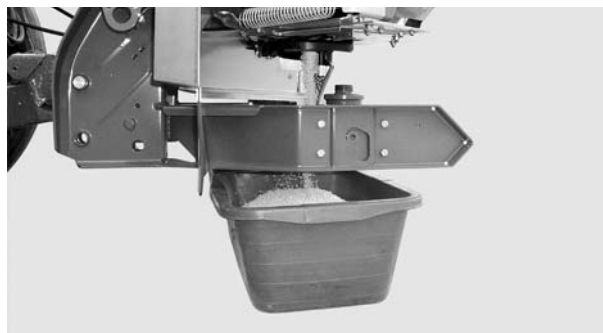
Rysunek 8.15: Przeprowadzenie próby kręconej
