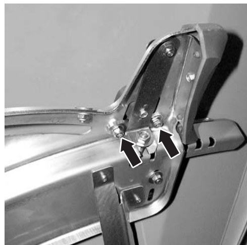
Rysunek 10.21: Odkręcanie blachy regulacyjnej punktu dozowania
