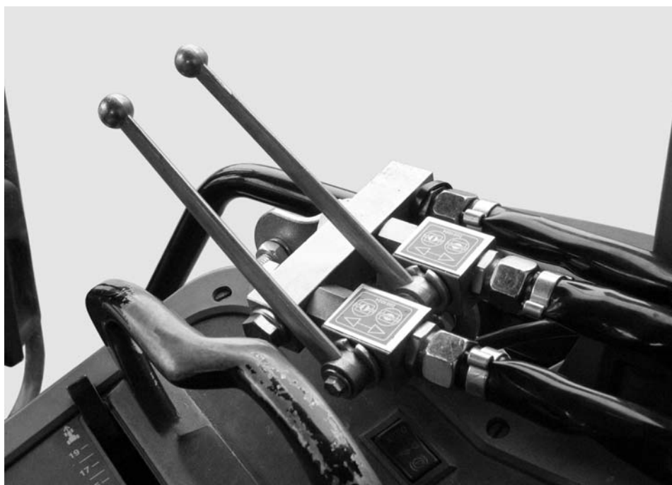
Rysunek 7.8: Układ sterowania zasuwami jednostki dwudrogowej
