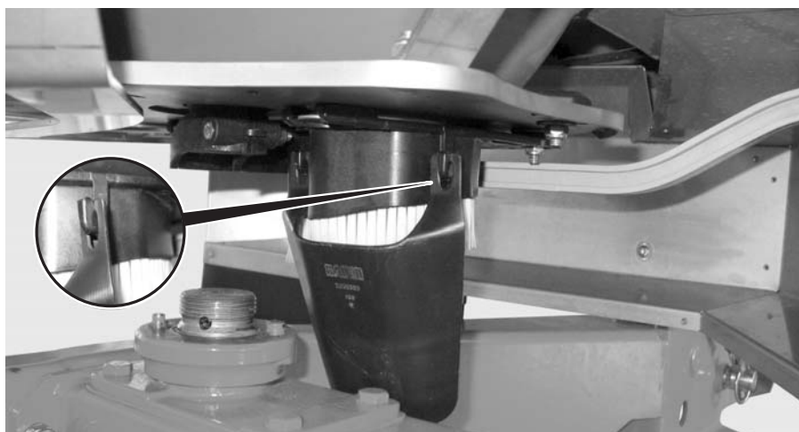
Rysunek 8.14: Zawieszanie zsuwni do próby kręconej
