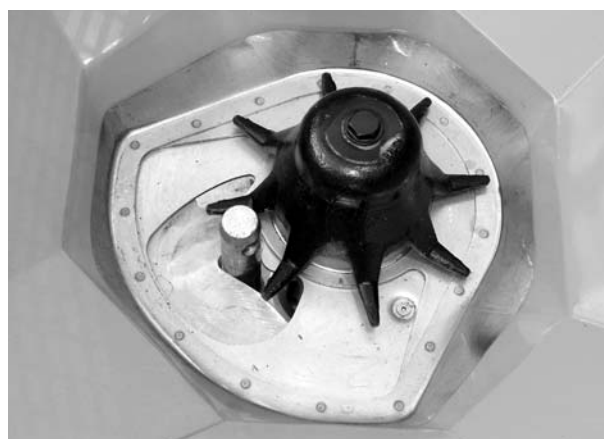
Rysunek 10.18: Trzpień dolnego ramienia podnośnika w otworze dozującym
