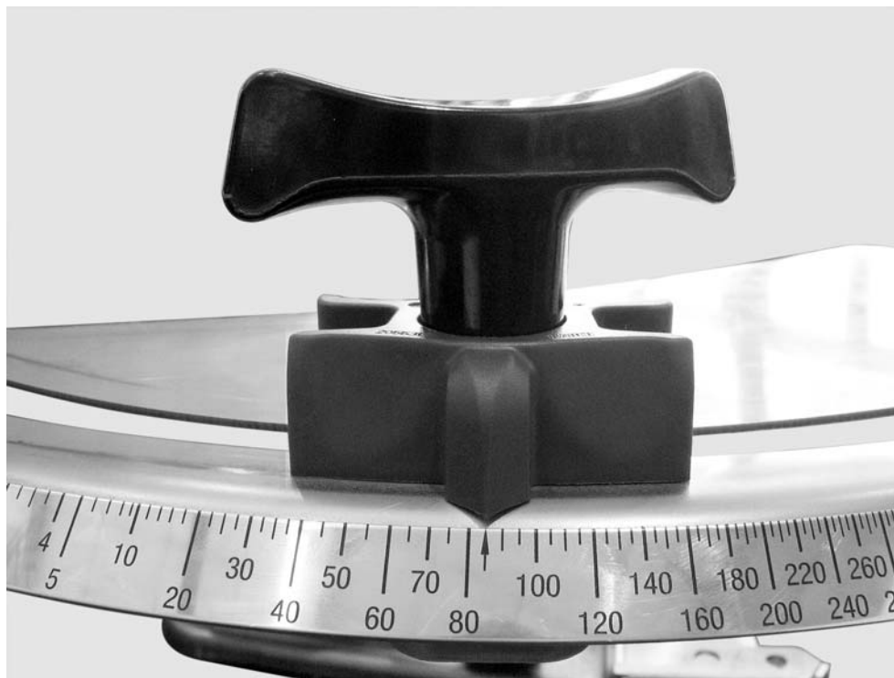
Rysunek 10.19: Skala do ustawiania zasowy dozującej
