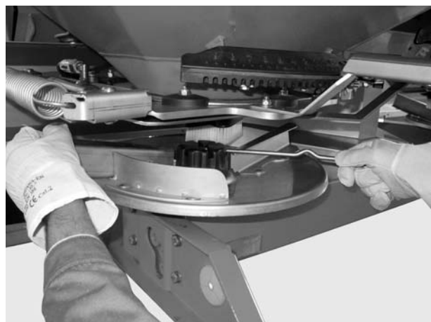
Rysunek 8.3: Luzowanie nakrętki kołpakowej
