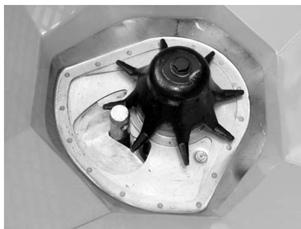
Figura 10.18: Perno del braccio inferiore nell'apertura di dosaggio
