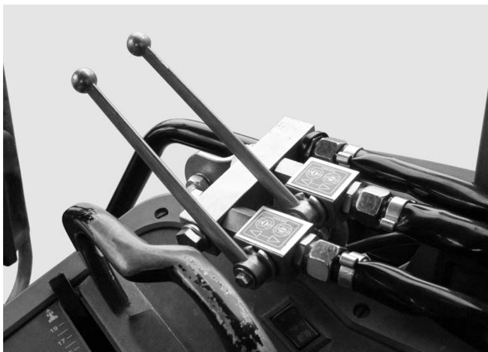
Figura 7.8: Comando dei dosatori dell'unità a due vie
