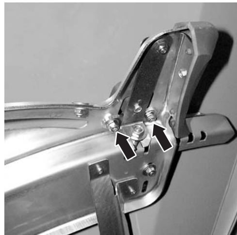
Figura 10.21: Staccare il pannello di taratura del punto di applicazione
