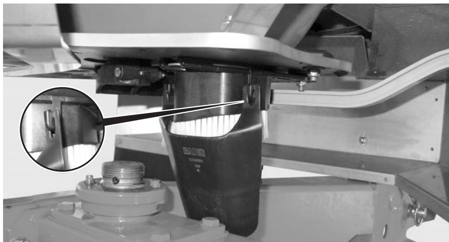
Мал. 8.12: Підвішування спускної труби для встановлення норми внесення добрива
