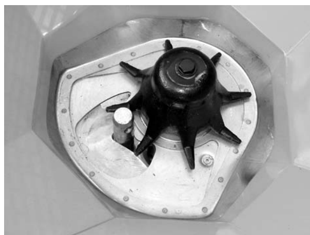
Мал. 10.14: Болт нижньої тяги в отворі дозатора
