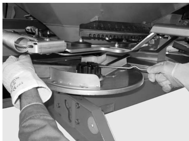
Мал. 8.3: Ослаблення ковпачкової гайки
