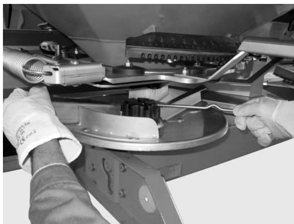
Мал. 8.11: Ослаблення ковпачкової гайки
