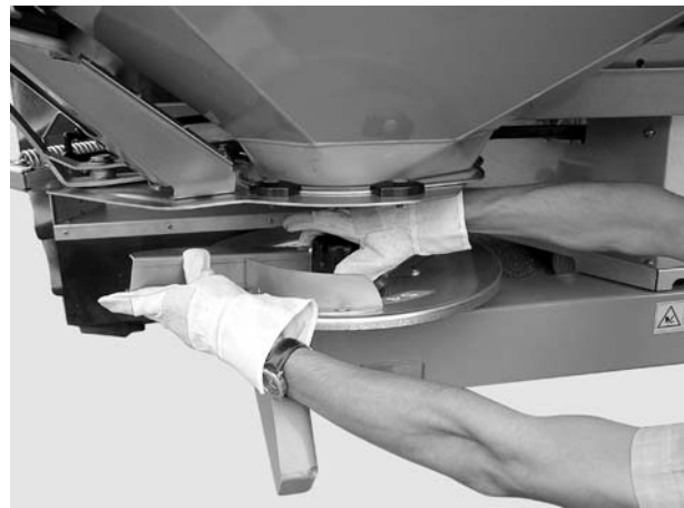
Мал. 8.14: Закручування ковпачкової гайки
