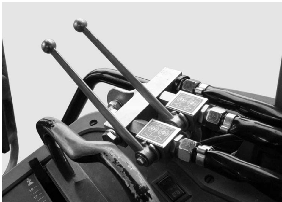
図 7.12: ツーウェイユニットのスライドアクチュエーター
