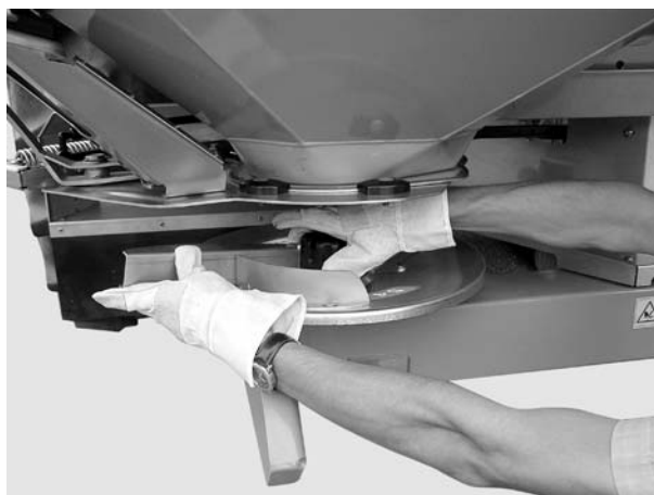
図 8.4: キャップナットを外す
