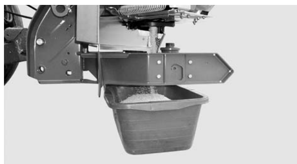
図 8.14: キャリブレーションテストの実施
