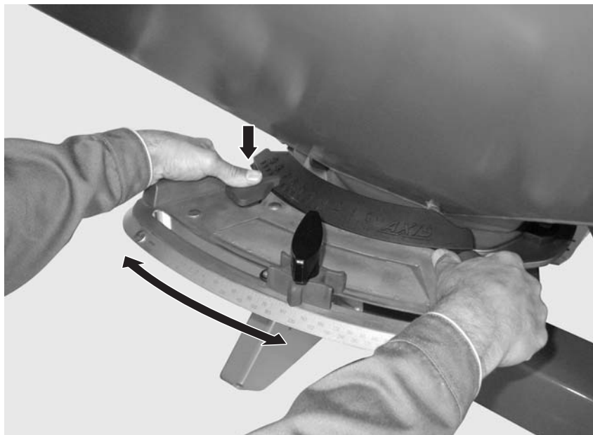
図 8.5: 肥料放出ポイント調整ユニット
