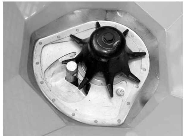
図 10.14: 計測アウトレットのロアリンクピン
