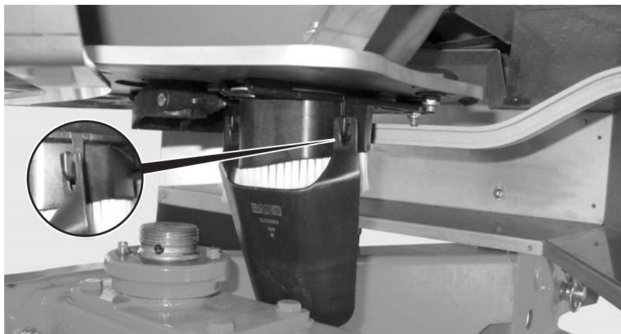
図 8.13: キャリブレーションテストシュートの取付け
