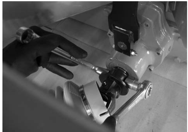
図 7.4: ドライブシャフトを固定
