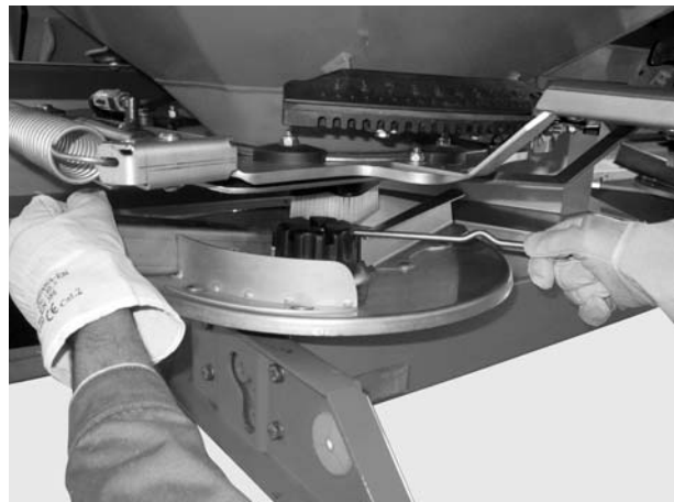
図 8.3: キャップナットをゆるめる
