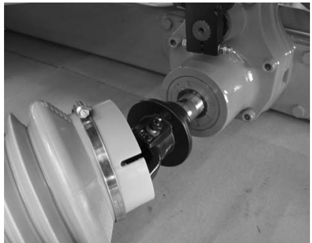
Kuva 7.3: Nivelakselin asettaminen vaihteistotapille
