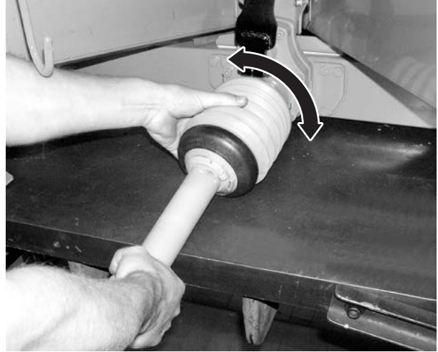
Kuva 7.8: Nivelakselin suojuksen asettaminen
