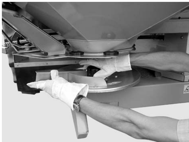
8.15. attēls: Kupoluzgriežņu pieskrūvēšana
