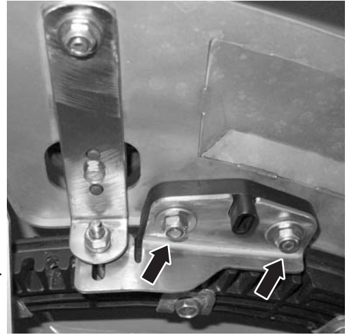
10.17. attēls: Padeves punkta regulēšanas plātnes atbrīvošana
