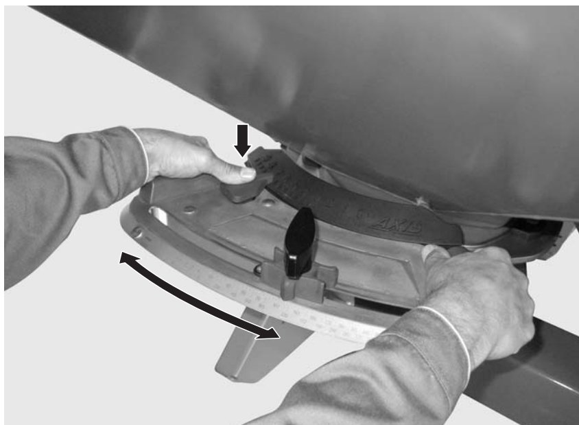
8.5. attēls: Padeves punkta iestatīšanas centrs
