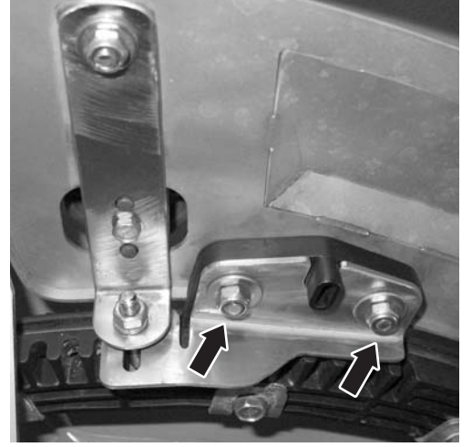
Resim 10.17: Gübre bırakma noktası düzeltme levhasının sökülmesi
