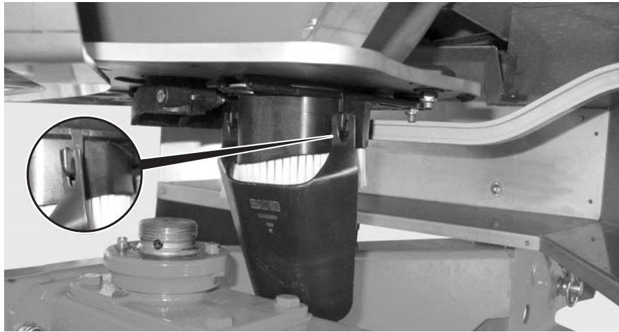
Resim 8.13: Kısma testi oluğunu takın
