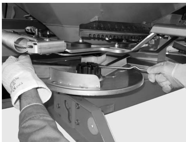
8.12 pav.: Gaubiamosios veržlės atlaisvinimas
