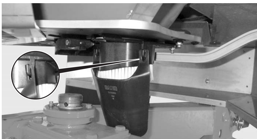
8.13 pav.: Išbėrimo normos nustatymo lataką įkabinimas
