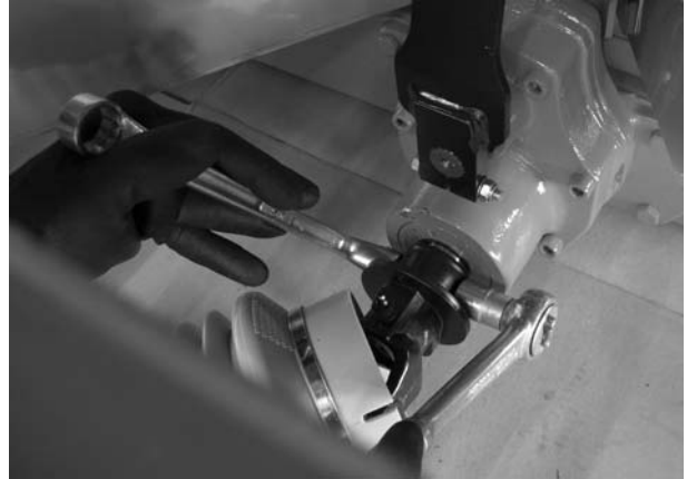
7.4 pav.: Kardaninio veleno pritvirtinimas
