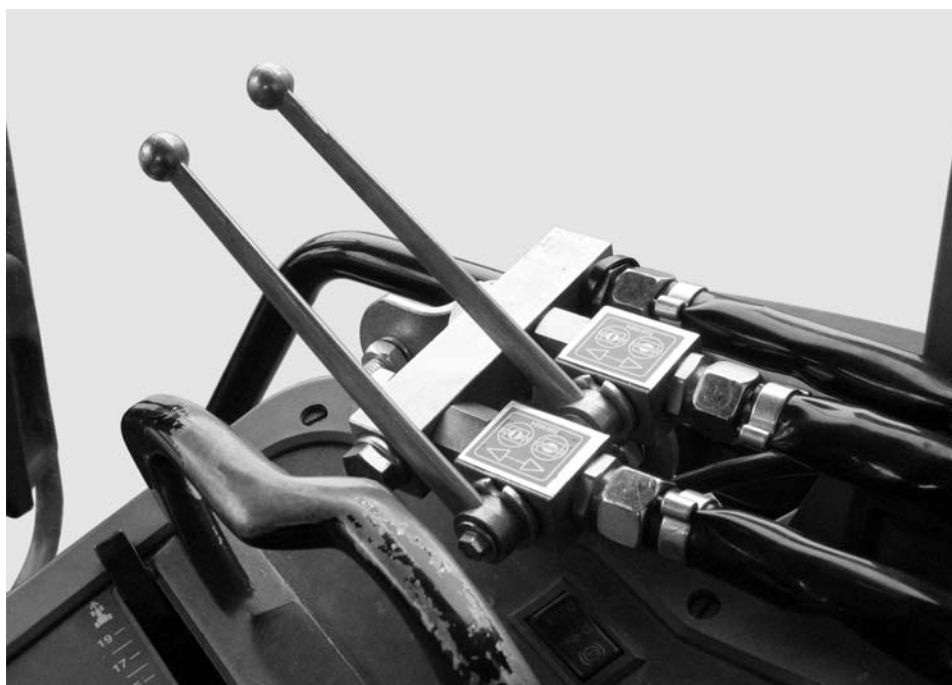
7.12 pav.: Dviejų eigų bloko sklendės valdymo įtaisas
