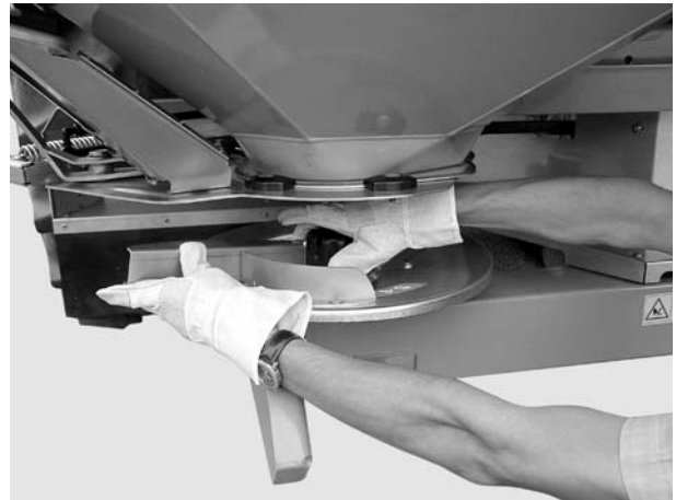
Joonis 8.15: Keerake kübarmutter lahti
