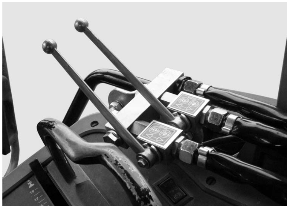
7.12 ábra: Kétutas szelep tolólapvezérlése
