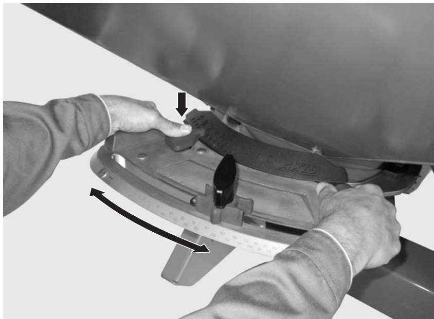
8.5 ábra: Feladási pont beállítóközpontja
