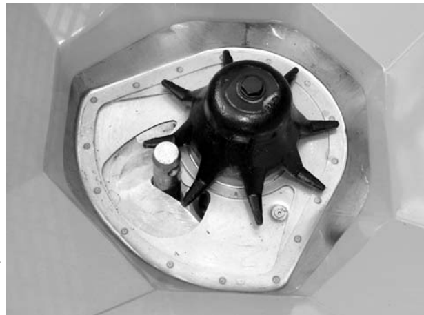
10.14 ábra: Alsó összekötőcsap az adagolónyílásban
