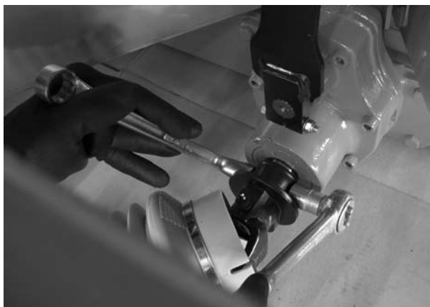
Slika 7.4: Pričvršćivanje zglobnog vratila
