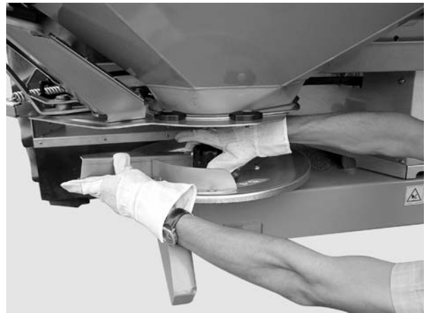
Slika 8.4: Odvijanje slepe navrtke
