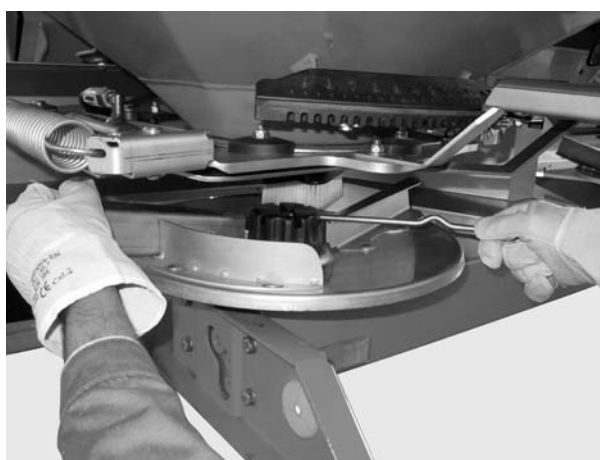
Slika 8.3: Olabavljanje slepe navrtke
