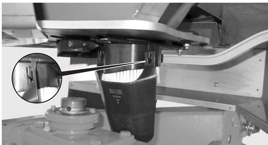
Imagem 8.13: Suspender o deslizador do teste de rotação
