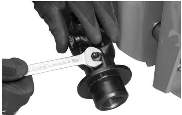
Imagem 7.2: Soltar o bocal de lubrificação
