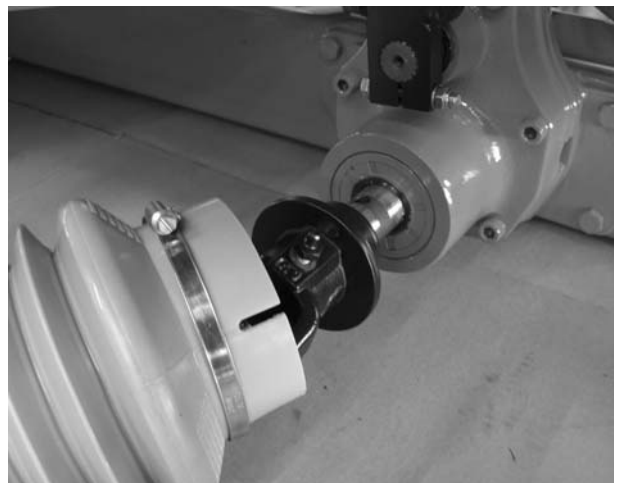
Рисунок 7.3: Надевание карданного вала на конец вала редуктора
