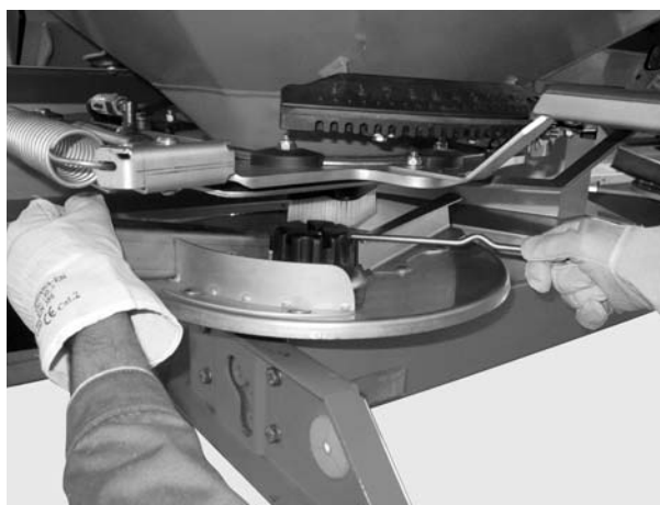
Рисунок 8.3: Ослабление колпачковой гайки
