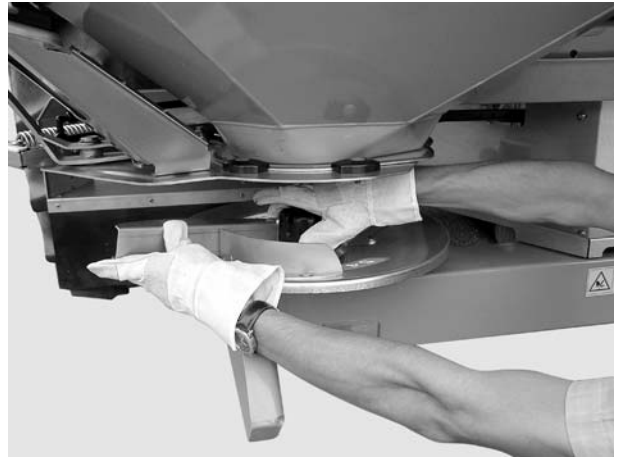
Рисунок 8.4: Откручивание колпачковой гайки
