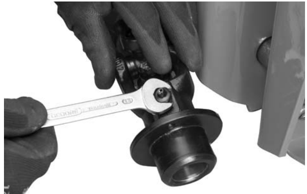
Рисунок 7.2: Отвинчивание смазочного ниппеля
