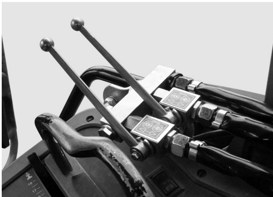
Рисунок 7.12: Управление заслонками с помощью двухходового блока Вы можете по отдельности управлять заслонками дозатора при помощи шаровых кранов двухходового блока.
