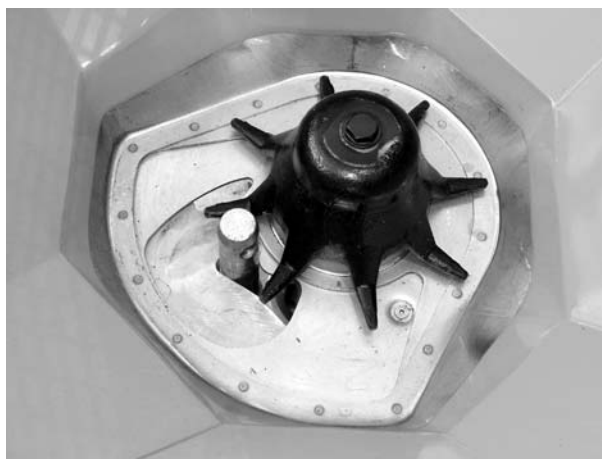
Bilde 10.14: Trekkstangbolt i doseringsåpning
