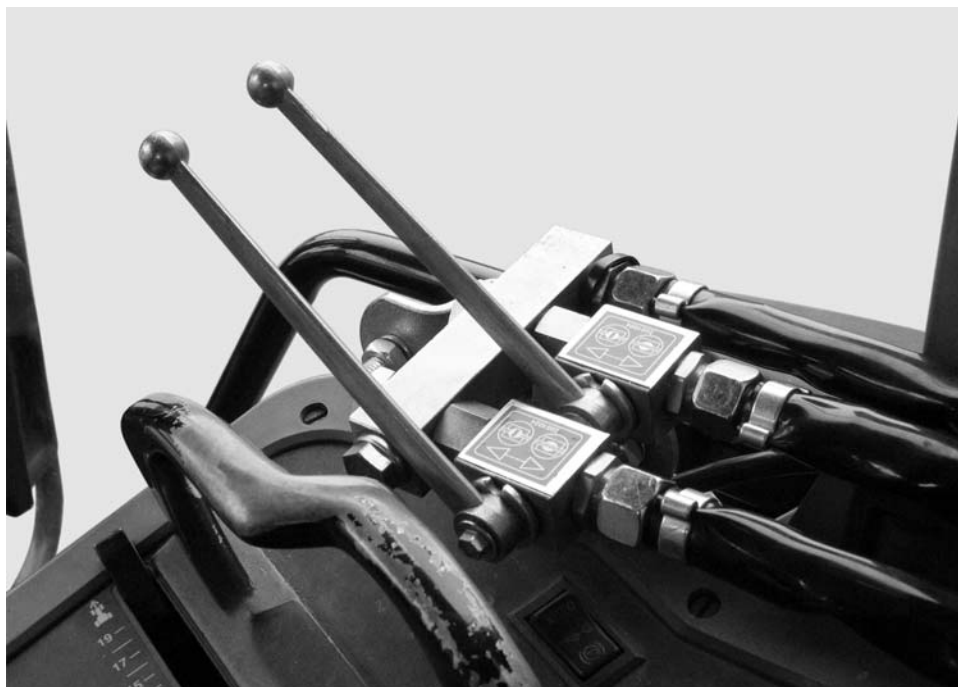
Obrázek 7.12: Ovládání hradítka z dvoucestné jednotky
