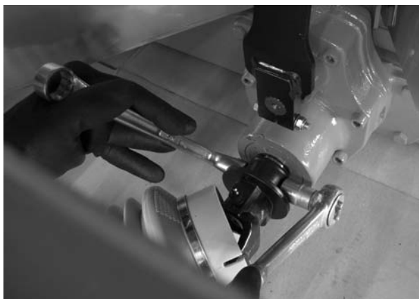
Obrázek 7.4: Upevnění kloubového hřídele
