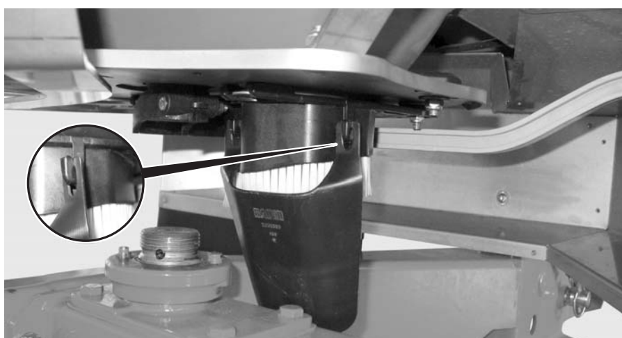
Obrázek 8.13: Zavěšení žlabu na provedení zkoušky dávky
