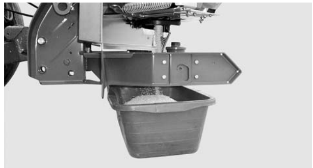
Obrázek 8.14: Provedení zkoušky dávky
