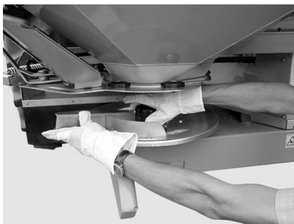
Obrázek 8.15: Zašroubování uzavřené matice
