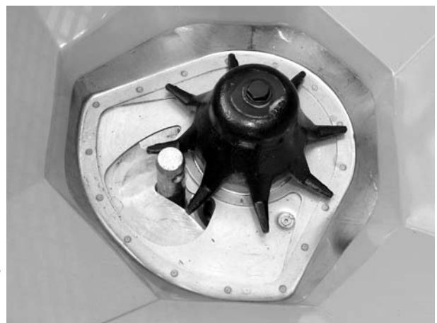
Obrázek 10.14: Čep spodní spojky v dávkovacím otvoru
