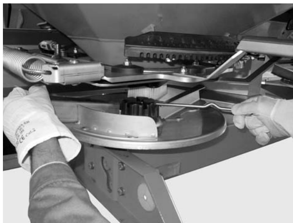
Obrázek 8.3: Povolení uzavřené matice
