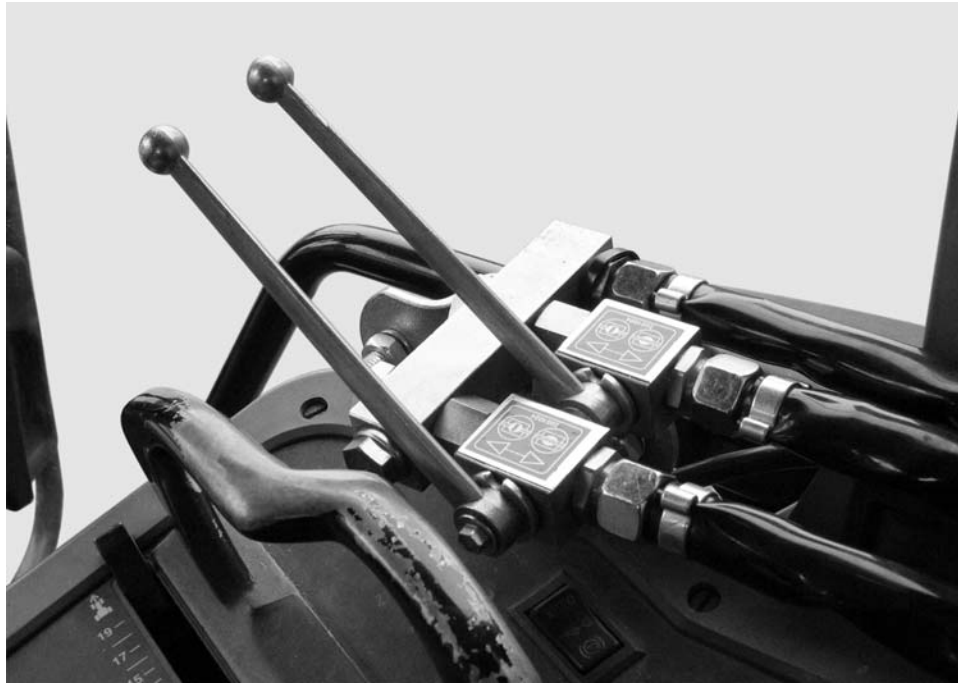
Bild 7.12: Slidstyrning av tvåvägsventilen
