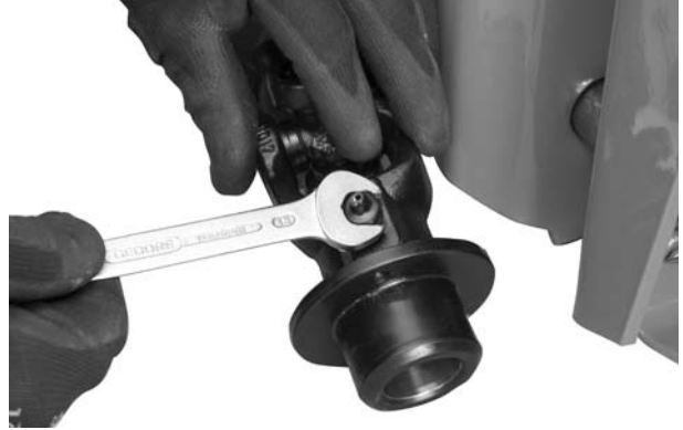
Slika 7.2: Otpuštanje nazuvice za podmazivanje
