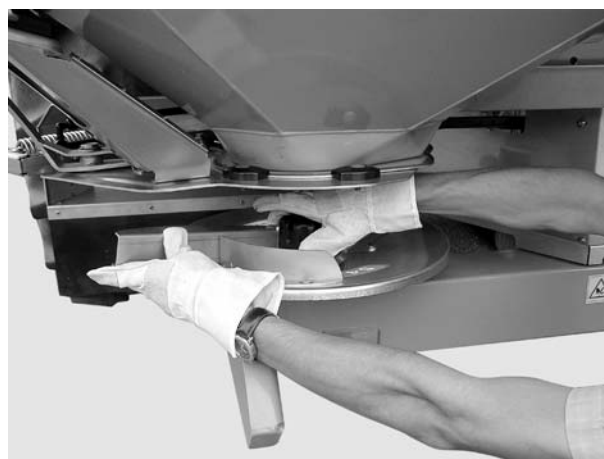
Billede 8.15: Iskruning af kalotmøtrikken
