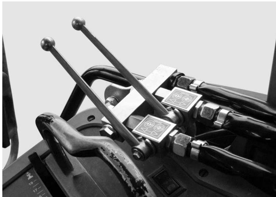
Billede 7.12: Skyderaktivering for tovejsenheden
