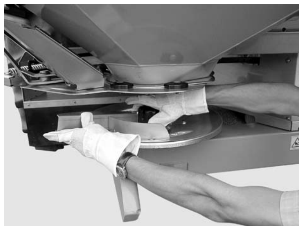
Billede 8.4: Udskruining af kalotmøtrikken
