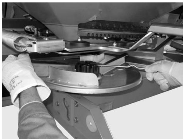
Billede 8.3: Løsn kalotmøtrikken
