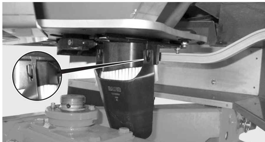
Imagine 8.13: Agățați jgheabul pentru proba de amestecare
