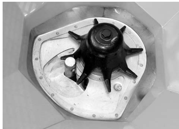
Εικόνα 10.14: Μπουλόνι κάτω συνδέσμου στο δοσιμετρικό στόμιο
