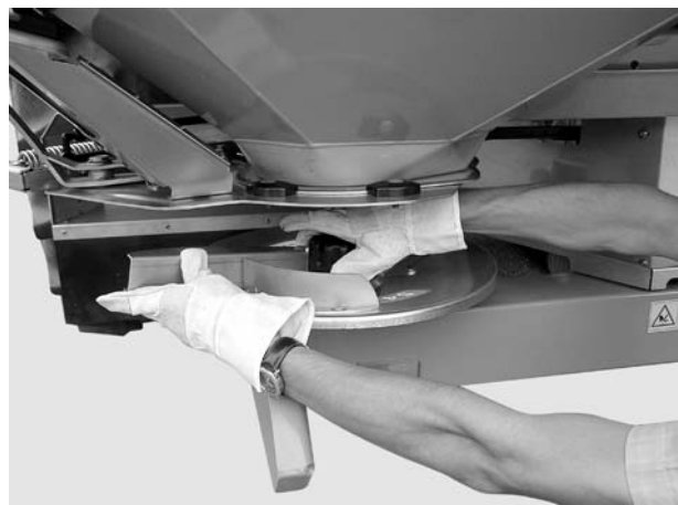
Εικόνα 8.15: Βίδωμα τυφλού παξιμαδιού
