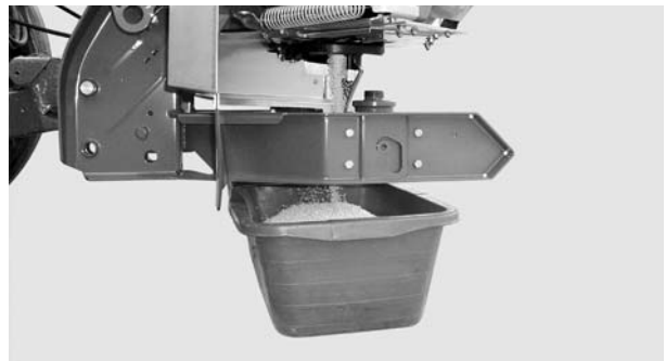
Εικόνα 8.14: Εκτέλεση δοκιμής βαθμονόμησης
