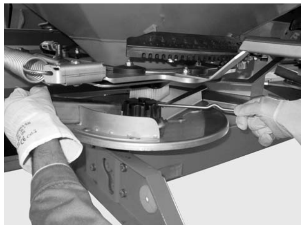
Εικόνα 8.3: Χαλάρωση τυφλού παξιμαδιού
