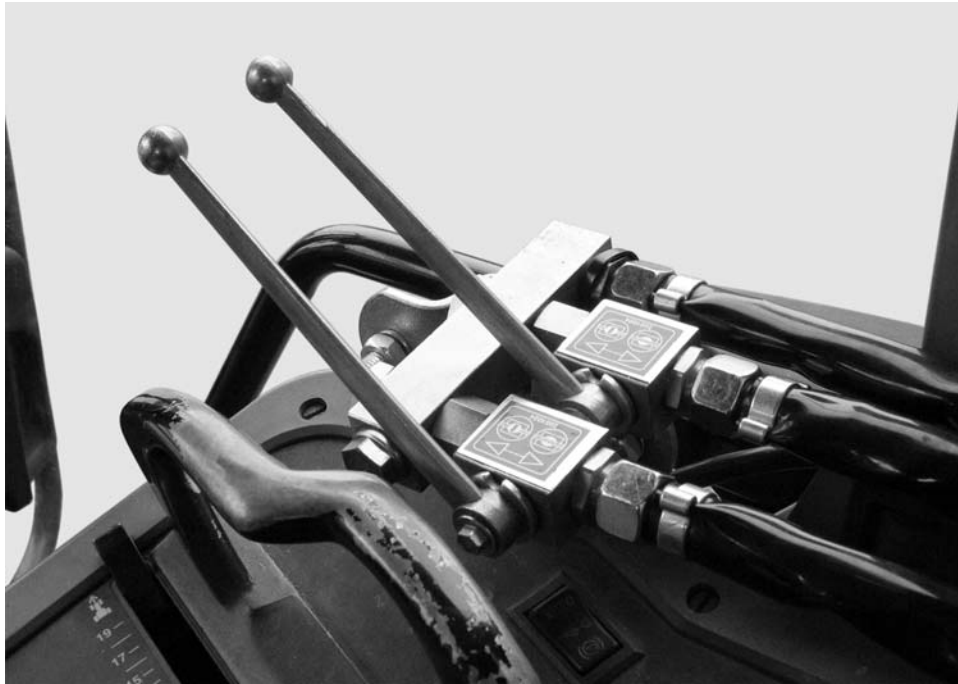
Εικόνα 7.12: Μηχανισμός θυρίδων της μονάδας δύο κατευθύνσεων
