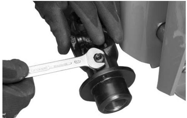
Εικόνα 7.2: Χαλάρωση στομίου εισαγωγής γράσου
