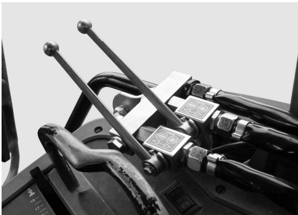
Фиг. 7.12: : Механизъм за задействане на шибърите на двупътния блок Дозиращите шибъри могат да се задействат по поотделно чрез сферичните кранове на двупътния блок.
