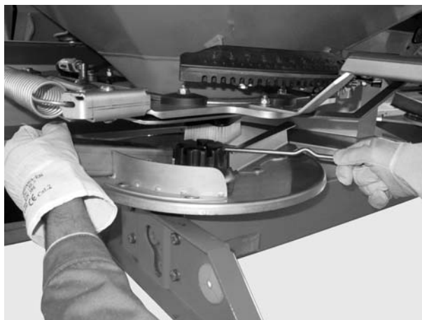
Rysunek 8.12: Luzowanie nakrętki kołpakowej
