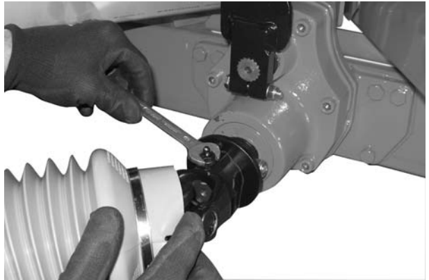
Rysunek 7.5: Dokręcanie gniazda smarowego do oporu
