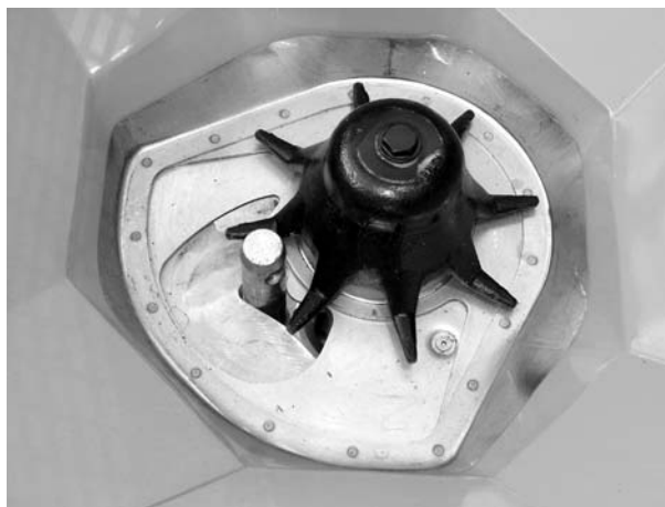
Rysunek 10.14: Trzpień dolnego ramienia podnośnika w otworze dozującym
