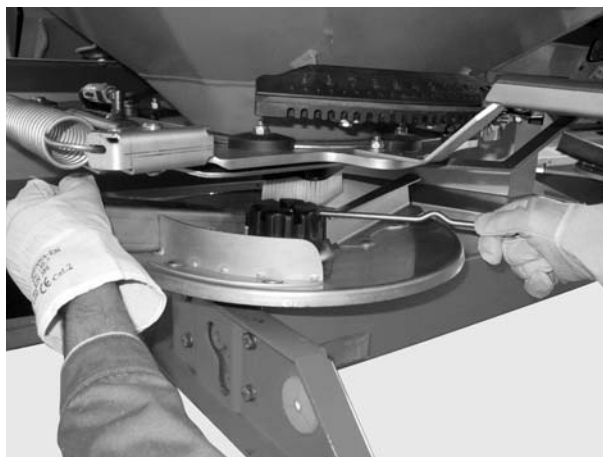
Rysunek 8.3: Luzowanie nakrętki kołpakowej
