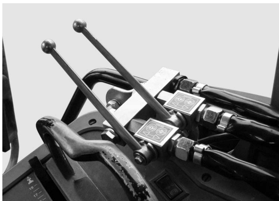
Rysunek 7.12: Układ sterowania zasuwami jednostki dwudrożnej
