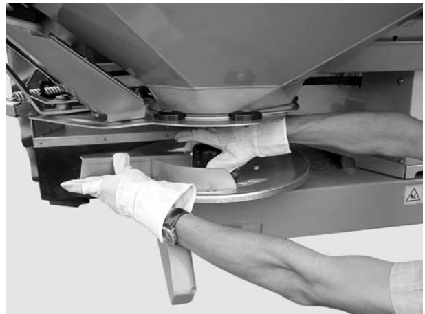
Rysunek 8.4: Odkręcanie nakrętki kołpakowej
