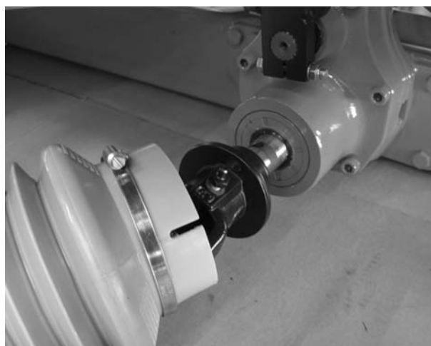
Rysunek 7.3: Wsuwanie wału przegubowego na czop przekładni
