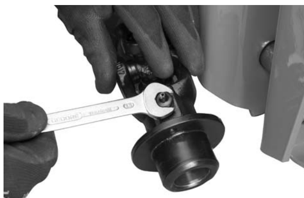
Rysunek 7.2: Luzowanie gniazda smarowego
