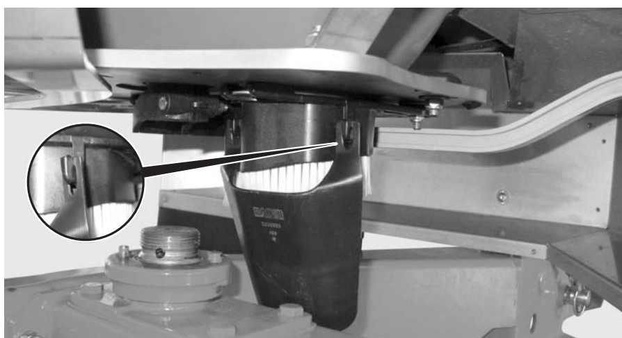
Rysunek 8.13: Zawieszanie zsuwni do próby kręconej
